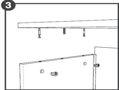
Arka parça yan ve alt parçadaki kanallara yerleştirilir. '4' numaralı parça monte edilir.
