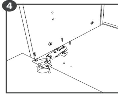
'1' numaralı vidalar yardımıyla menteşeler öncelikle kapaklara, sonrasında dolap gövdesine monte edilir.
