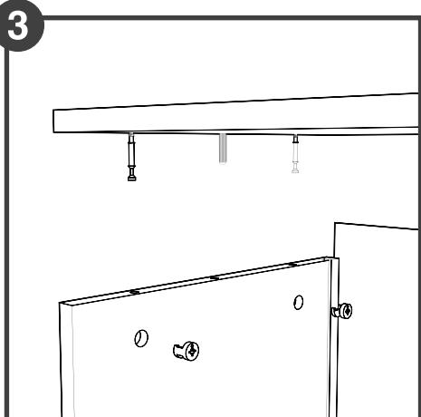
Arka parça yan ve alt parçadaki kanallara yerleştirilir. '4' numaralı parça monte edilir.
