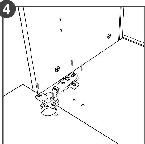
'1' numaralı vidalar yardımıyla menteşeler öncelikle kapaklara, sonrasında dolap gövdesine monte edilir.
