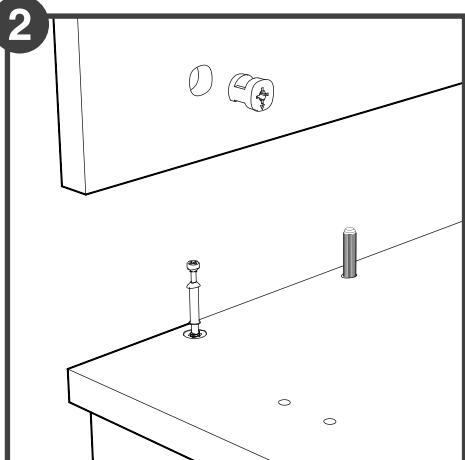
Aynı parçanın diğer yüzeyine '3' numaralı minifix mili ve '5' numaralı kavilyalar takılarak '2-3-5' numaralı parçalar monte edilir. '4' numaralı minifix başı üzerindeki ok milin gireceği yönde olarak monte edilir.
