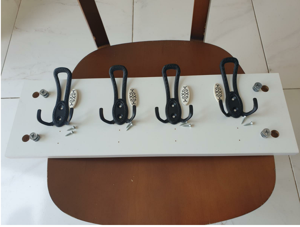
Askılık için gerekli olan parçaları (minifix gövdesi x4, askı x4, 3.5x18mm x8, askı kapağı 4x)
