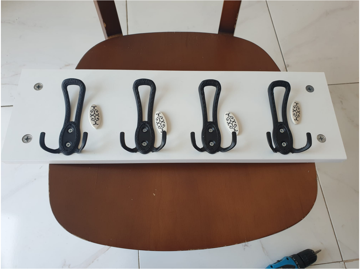
Minifix gövdelerini ok deliği gösterecek şekilde yerleştiriniz. Askıları 3.5x18mm vidalar ile iz yerlerinden sabitleyiniz. Askı kapaklarını takınız.
