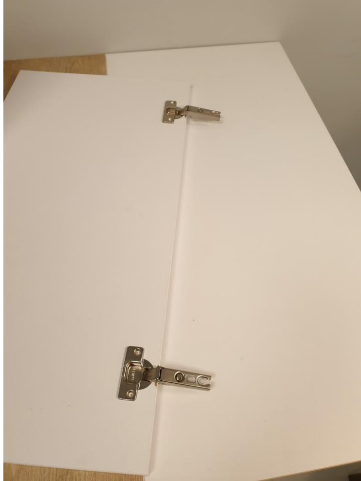
Daha önce ayırdığımız kapak parçalarına menteşelerimiz resimdeki gibi denk gelecek şekilde yerleştiriniz.
