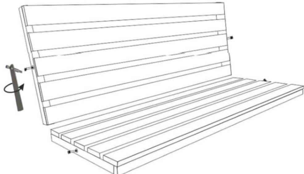
Önce oturak üzerinde takılı gelen vidaları söküñüz.
