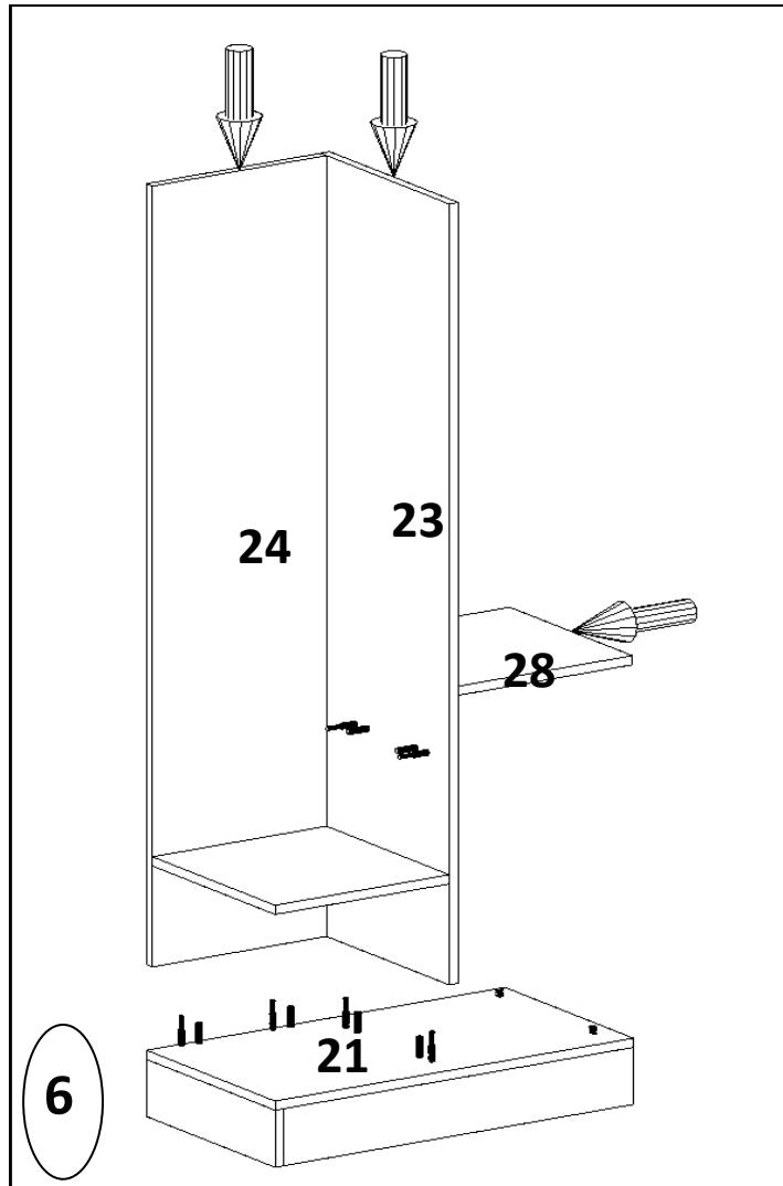
**Şekil6:** Dolabın alt tablasına orta dikmeyi yerleştiriniz ve minifix vidalarını sıkınız.
