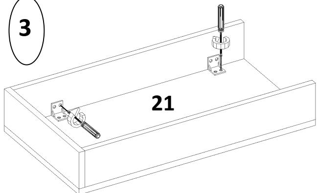
Şekil 1 de masa ayağını ve masa masa perdesini minifix miline yerleştirip minifix vidalarını sıkınız. Oluşturduğunuz parçayı şekil 2 deki gibi masa üst parçasına yerleştirip minifix vidalarını sıkınız. Çalışma masasının alt tablasının bazalarını L plastik aparat ile 3,5x17 vida ile sabitleyiniz. Şekil 4: dolapın arka panosuna önce sabit rafı yerleştiriniz ardından orta dikmeyi yerleştiriniz ve minifx vidalarını sıkınız.
