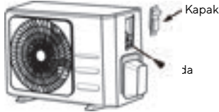
Kablo kelepçesi aşağıdaki gibi görünüyorsa kablounun çapına göre uygun açık deliği seçin.
