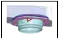
Şekil 2H Boğaz üzerinde bulunan çentikten geçirmiş olduğunuz kanallı halkayı ve 3 civatalı halkayı alyan anahtarını yardımıyla sıkınız
