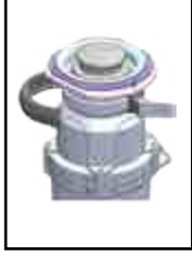
Şekil 2B Keleçmeyi cihazın üzerinden çıkarınız
