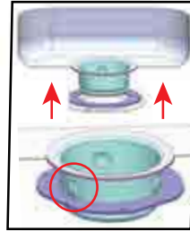
Şekil 2D Anahtar yardımıyla boğaz üzerinde bulunan civataları sökünüz
