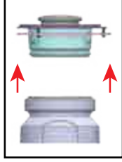
Şekil 2C Metal çöp giriş boğazını yukarı çekerek çıkarınız
