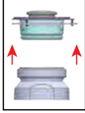
Şekil 2C Metal çöp giriş boğazını yukarı çekerek çıkarınız
