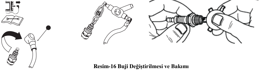
Resim-16 Buji Değiştirilmesi ve Bakımı
