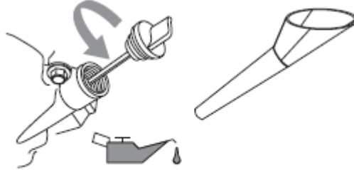
Resim-12 Huni ile Yağ Doldurma
