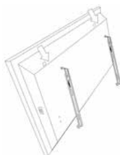
Obr. 8 Uchytenie spodnej časti konvektora
