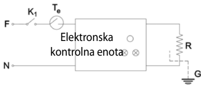
Slika 3. Električna shema digitalnega panelnega grelnika
