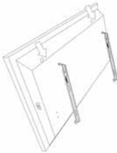
Şekil 10. Üst kancanın takılması arkadan görünüş
