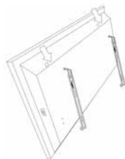
Slika 10. Prikaz montaže gornje kuke na zadnjem panelu
