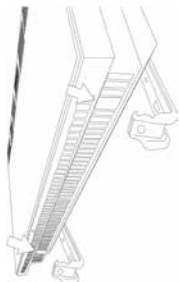
Slika 8. Postavljanje konvektora na donju kuku
