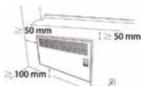
Obr. 6 Minimálne bezpečnostné zóny potrebné pre účinnosť spotrebiča
