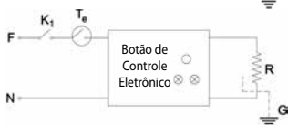
Figura 4. Diagrama do Circuito Elétrico do Convector de Painel com Unidade de Controle Digital
