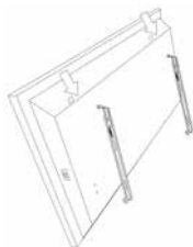
Figura 10. A vista traseira da montagem de gancho superior
