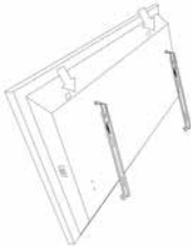
الشكل ١٠ منظور خلفي تركيب جهاز لوح التسخين الكهربائي على الخطافات العلوية
