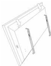
Figura 10. L'inserimento del gancio superiore, veduta da dietro
