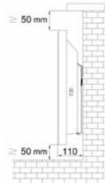
الشكل ١١ مقابيس جهاز لوح التسخين الكهربائي بعد التركيب
